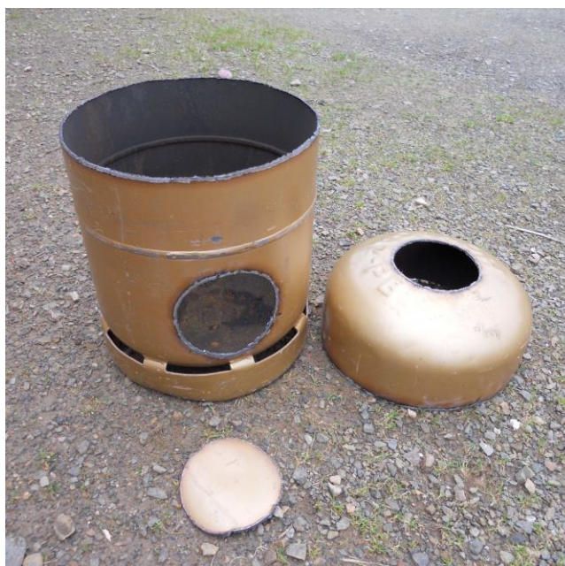
Découpe du bidon et perçage des trous
