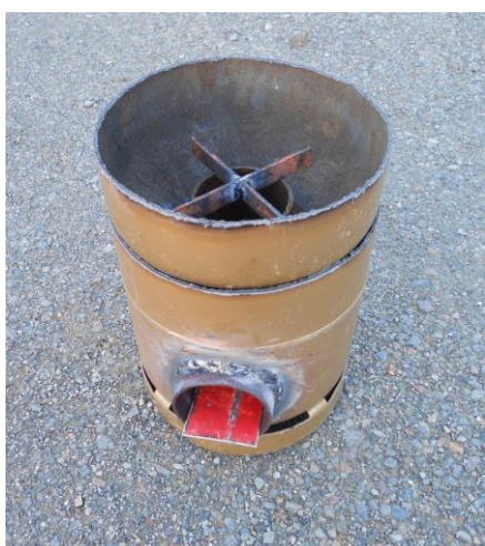
Mise en place du coude
